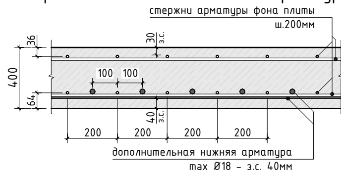
Схема раскладки стержней фоновой и дополнительной арматуры
